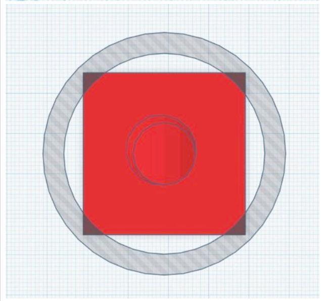
Arrondir les angles sur le dessus en réalisant un volume avec 2 paraboloïdes dont vous choisirez les dimensions.
